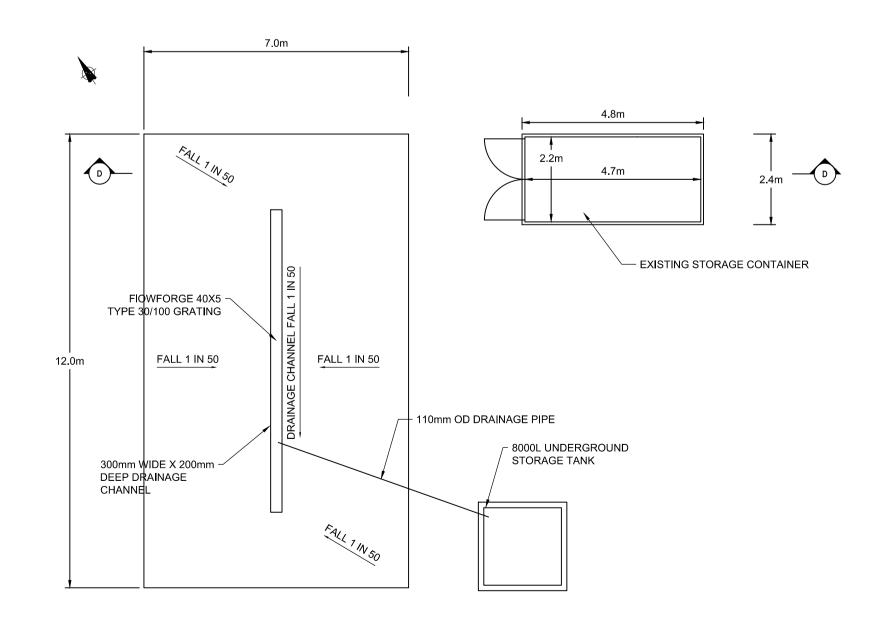
EXISTING VEHICLE WASH SLAB & STORAGE COMPOUND PLAN VIEW
